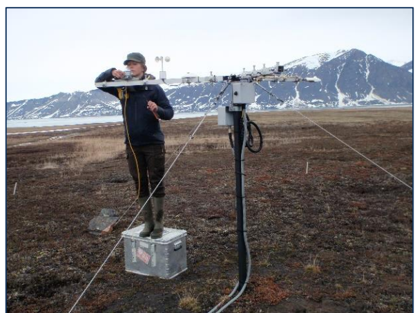
Udskiftning af sensorer ved klimastation i Zackenberg Foto: Stefan Jansen
